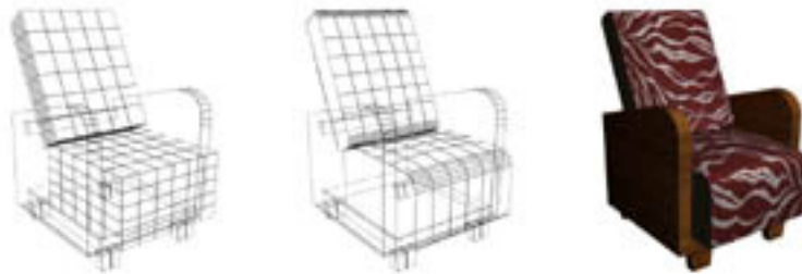
Fig. 20. Esempio di modellazione applicato alla poltrona presente nello studio degli anni '30: si parte da oggetti base come parallelepipedi e si modellano come farebbe uno scultore per ottenere un risultato realistico.
