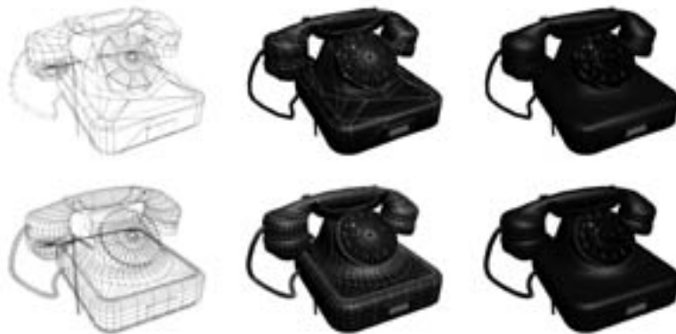
Fig. 21. Esempio di Lod sul telefono degli anni '30: in alto le geometrie e il risultato a bassa risoluzione sufficiente ad una certa distanza, mentre in basso quello più risoluto necessario quando ci si avvicina all'oggetto.
